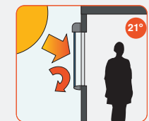
Con sistema de protección solar exterior
